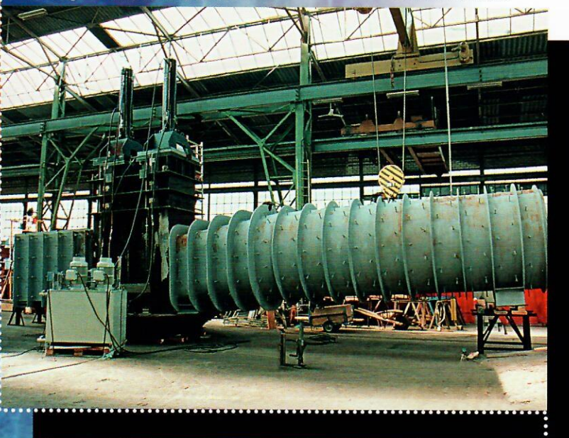
Bifurcation diam. 7,74/4,88/4,88 m Distributor diam. 7,74/4,88/4,88 m Abzweiger Durchm. 7,74/4,88/4,88 m
